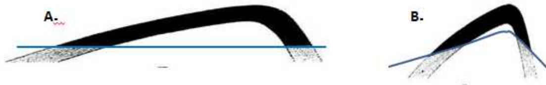
図 4-2-1-2. 固定された水平接触面が背斜構造の成長によって変形した見掛けの傾斜接触面 (Versluys, 1932 ; 原図を改変・加筆)。A. 水平接触面。接触面直下での水層のセメント作用などにより接触面が固定されることもありうる。B. Versluys (1932) の提案するモデルは、A の接触面が、背斜構造の両翼の傾斜の増加により合掌型に傾斜し、水平面から変動したもののモデルであった。上方粗粒化の堆積層では、堆積時に横方向に粒度が一定していたとしても、構造変形後、水平方向に粒度が変化するように配列されることになる。このモデルでは、油ガス田全体に亘って、一様な傾斜する接触面の形成機構を説明することは出来ない。ここでもセメント作用による接触面と見掛け上の固定によって、背構造の形成に伴い、接触面が変形したように見える場合もある。
