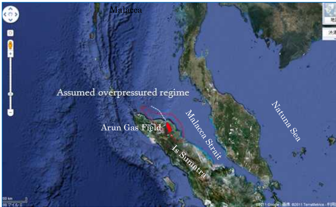
図 6-2-1-1. インドネシア・北スマトラ島北岸沖浅海域。Arun ガス田（異常高圧帯）の地層構造とその北への延長部（静水圧帯）の中間領域での類型Ⅱ型の探鉱リードが提案できる。
