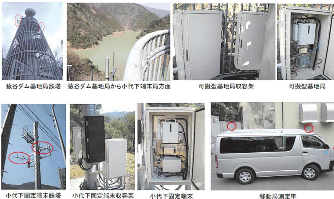
図2 開発した VHF 帯移動通信システムのフィールド（奈良県五條市）実証実験
