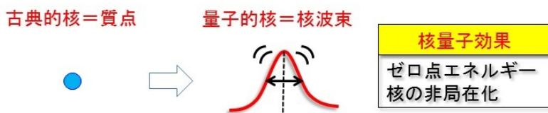
図 1：水素核を質点ではなく核波束として扱うことでの、核の量子効果（＝核のゼロ点振動と非局在化）を取り入れることができる。
