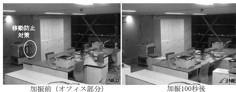
図 3-39 実験室 2 の室内状況とコピー機の移動防止対策
