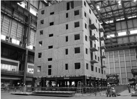
図7 7階建ての震動台実験 5)
