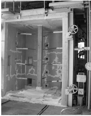
図5 耐火木造柱の耐火実験 4)
