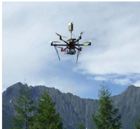
図6 CWSを搭載して飛行するUAV
