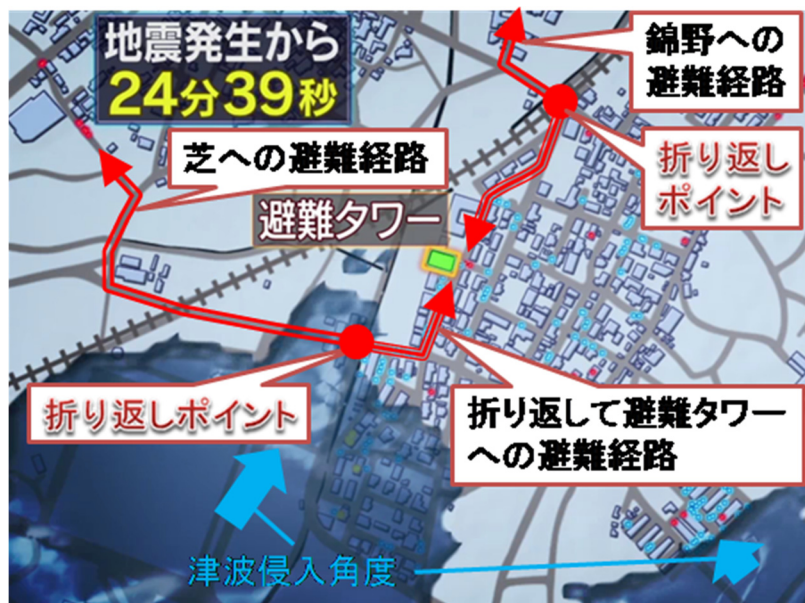
Fig. 3-12 代替案 4：避難先の変更（変更を判断する折り返しポイントの設定）
