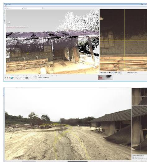
図-8 MMS による浸水痕跡調査の様子
