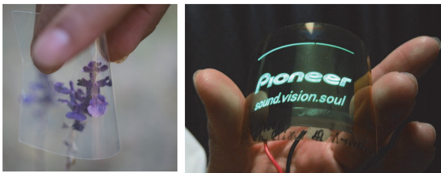
図6：セルロースナノファイバー補強透明材料（左）とそれを基板に用いた有機EL発光素子
