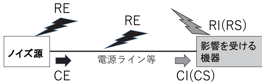
図 1: EMC 規格のイメージ図. ノイズを出す側、受ける側にそれぞれ規格が存在する.
