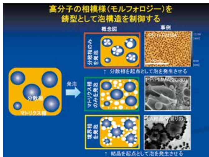
図5 高分子の相模様(モルフォロジー)を鋳型として気泡構造を制御
