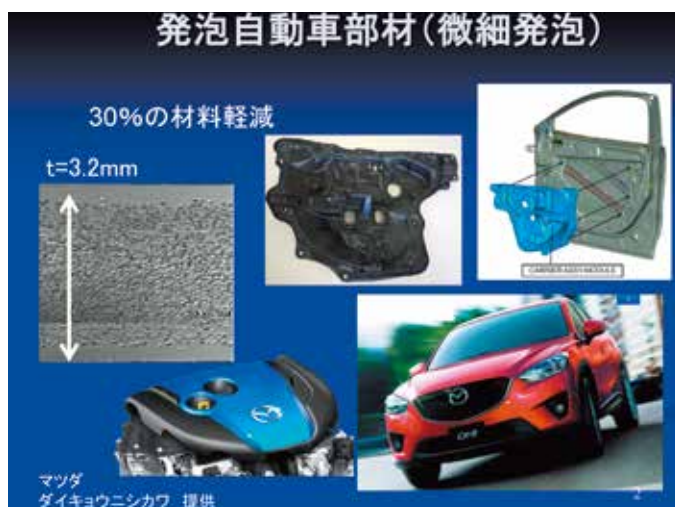
図2 発泡自動車部材の例(マツダ・ダイキョウニシカワ提供)
