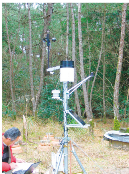
平成23年度に設置した温湿度計、気圧計、雨量計、風向・風量計から構成される気象測器
