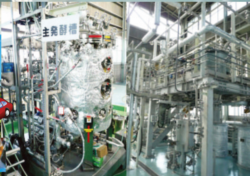
マイクロ波と高速醗酵細菌を用いたバイオマス変換プラント
