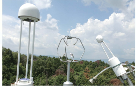
森林樹冠上の測器 左からメタン分析計、超音波風速計、二酸化炭素分析計
