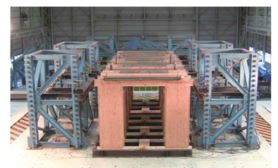
図3 同時加振実験 (同じロット、同じ職人、同じ仕様の試験体に同じ入力)
