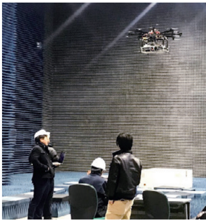
図1：2015年に実施したドローンからのワイヤレス給電を用いた電池レスセンサー実証実験
