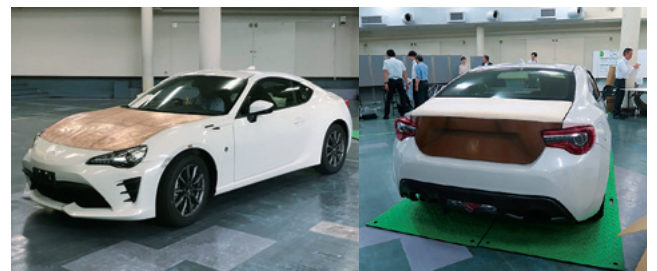
図1: 試作車1号(左) エンジンフードをRTM試作品(CNF+エポキシ樹脂)に置換(右) トランクリッドをCNF100%とPA6-CNF5%射出成形品に置換(2018年6月6日成果報告会にて)
