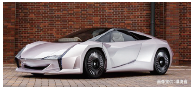
図1: 試作車1号(左) エンジンフードをRTM試作品(CNF+エポキシ樹脂)に置換(右) トランクリッドをCNF100%とPA6-CNF5%射出成形品に置換(2018年6月6日成果報告会にて)
