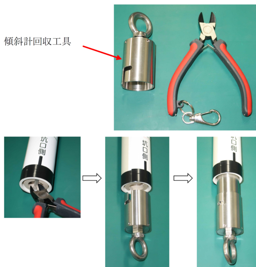
図 4-19 傾斜計測ユニット回収治具
