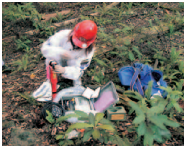
地震計およびデータロガーの設置作業
