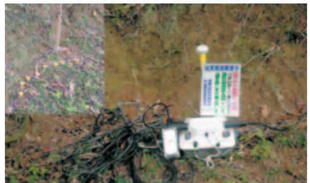
図6 地震計(左上の黄色のもの)とレコーダ、地震計は6~9台がセットで1観測点に設置された。このレコーダは6成分からなり、50~100m間隔で6点の観測ができる。GPSのアンテナを装備し、この時計で離れた観測点でも1msの精度で記録の同期が可能になる。新宮-舞鶴測線ではこのレコーダが240kmにわたって、300個以上設置され、他の計器と併せて約2400点の記録がとられた。
