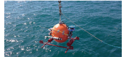
船から海へ投入される海底地震計。この後20分程度で海底に到着し、約1年間の観測を開始しました。
