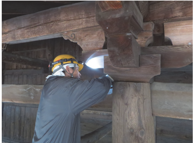
図1：柱材における樹種識別のための試料採取の様子。採取した試料はラベリングし撮影する。
