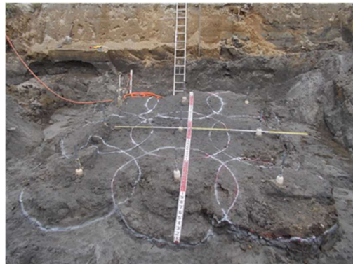
写真-3.1.7 改良体の発掘全景（唐津実証試験）
