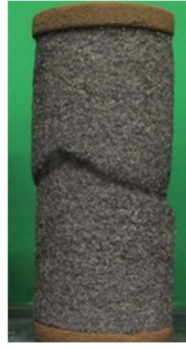
写真-3.1.15(a) 試験後供試体写真 写真-3.1.15(b) 試験後供試体写真 写真-3.1.16 試験後供試体写真 (Type A GL-2m~3m) (Type A GL-4m~5m) (Type B)
