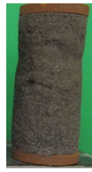
写真-3.1.15(a) 試験後供試体写真 写真-3.1.15(b) 試験後供試体写真 写真-3.1.16 試験後供試体写真 (Type A GL-2m~3m) (Type A GL-4m~5m) (Type B)
