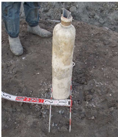
写真-3.1.12 発掘した地山パッカ (津島実証試験)
