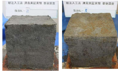
写真-3.1.12 ブロックサンプリング試料
