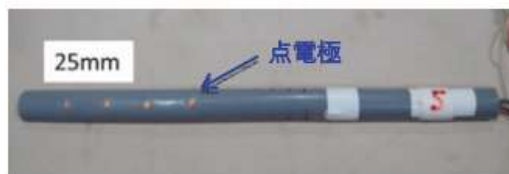
写真-3.2.1 実験に用いた電極プローブ
