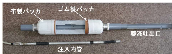
写真 3.1.1 地山パッカの構造
