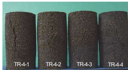
写真-3.1.14 一軸圧縮試験後の供試体 (TR-4)
