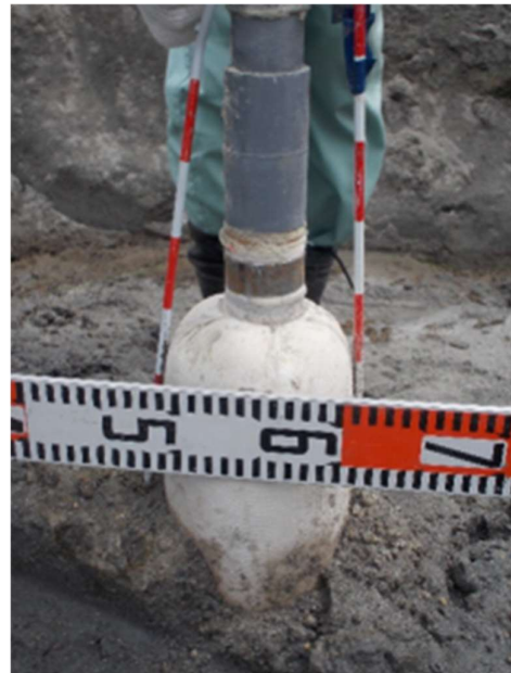
写真-3.1.6 発掘地山パッカ（唐津実証試験）
