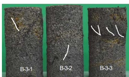
写真-3.1.10 一軸圧縮試験後の供試体（B-3）
