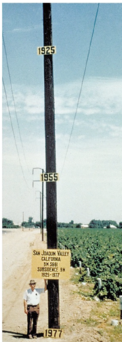
図1-4 カリフォルニア、メンドサ付近の San Joaquin Valley において撮影された地盤沈下 (Pictured is Dr. J.F. Poland; photograph by R.L. Ireland, USGS, ca. 1977) [Galloway and Burbey, 2011]
