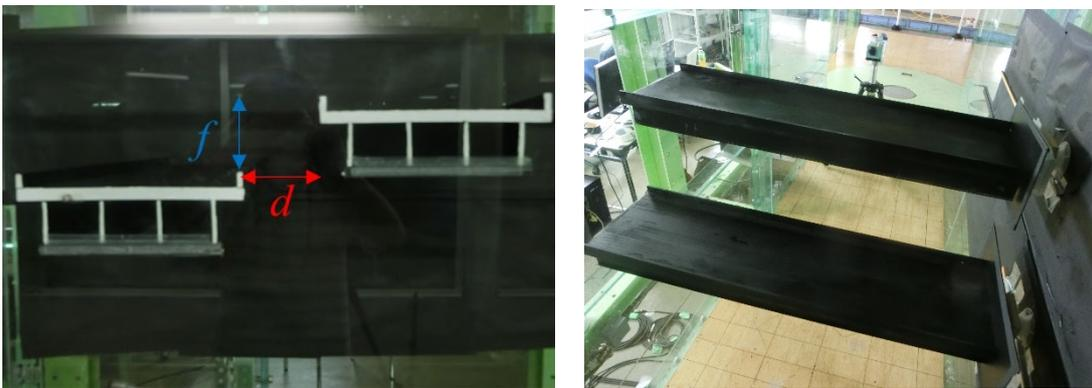
Fig. 5.2.2 可視化実験における橋梁模型のセッティング例
