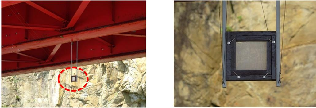
Fig. 3.6.3 ガーゼ法捕集装置の設置状況
