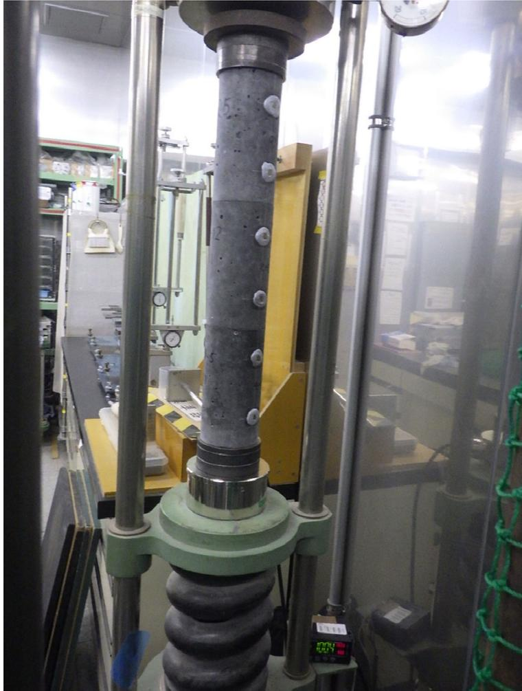
図 3.21 クリープ試験の様子(GPC-39 試験体)
