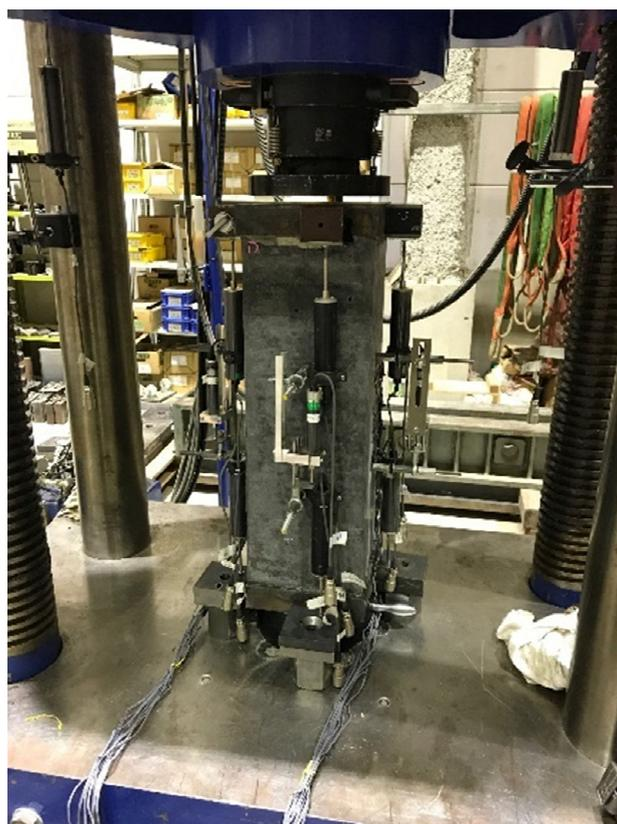
図 4.2 変位計の設置状況
