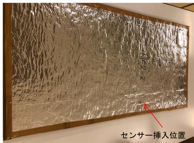
図 4.17. 試験体 B-2 とセンサー挿入位置
