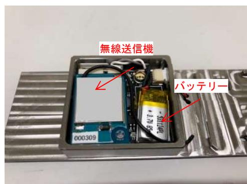
図 3.5. 無線送信機、バッテリーを搭載した外観
