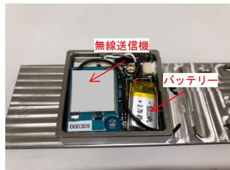
図 4.6. 無線送信機、バッテリーを搭載した外観
