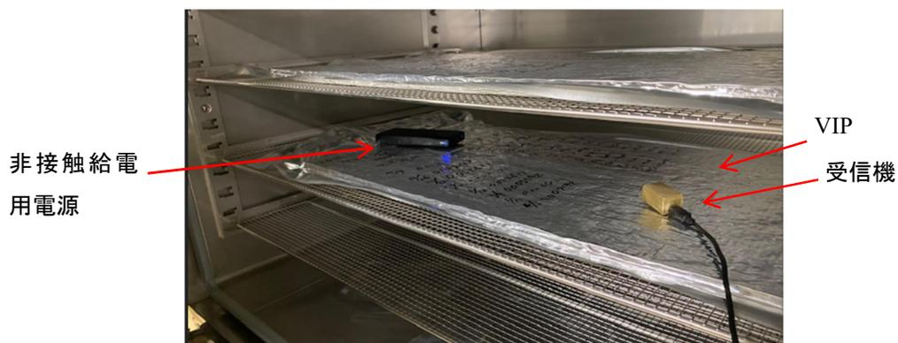
図 3.16. 恒温槽内に静置された試験体と、センサーへの充電及びデータを受信の様子
