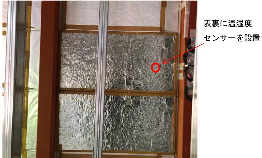
図 4.18. 試験体 B-2（センサー入り）の施工状況（吹付ウレタン被覆前）
