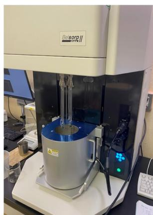
図 3.1. 蒸気吸着測定装置 (BelsorpMaxII)
