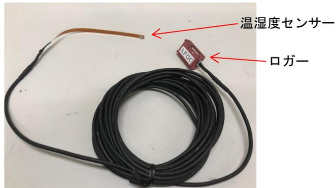
図 4.19. フレキシブルケーブルに接続された温湿度センサーとロガー
