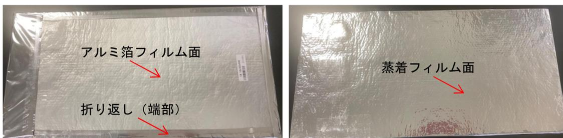
図 2.1. VIP 試験体外観（左：アルミ箔フィルム面 / 右：蒸着フィルム面）
