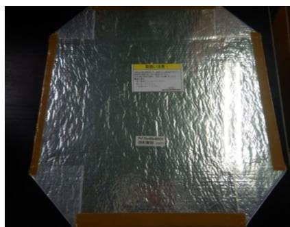
図 3.3. 差圧法（重量変化）の実験に用いた VIP 外観
