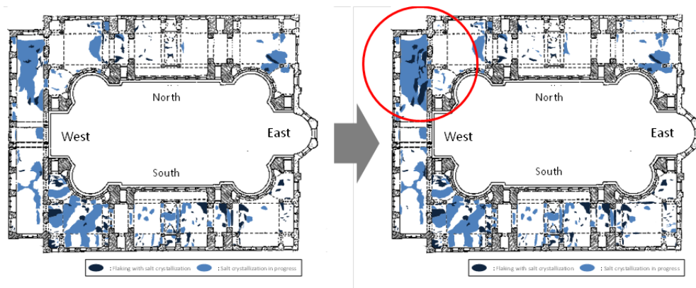
図 2.12 ギャラリー階の天井における塩の析出の進行 (左: 2006, 右: 2010) 2-7)
