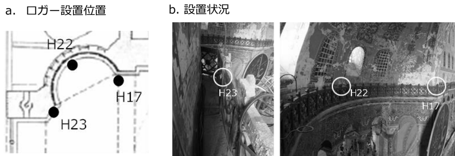
図 4.6 北西エクセドラにおける温湿度ログターの設置位置と設置状況 [4-1]
