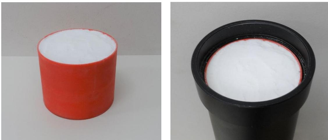
図 2.4 粒子状材料の試験体
