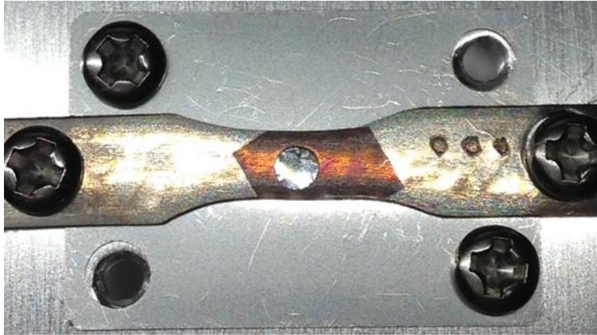
図 2.19 自作の金属フレーム上に作製した自立薄膜標的
