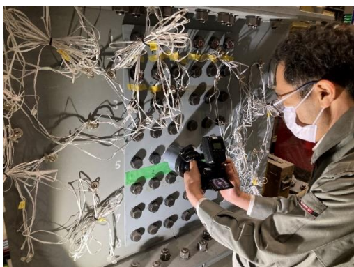
(g) ボルト B : 画像計測状況
