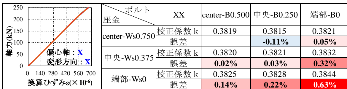
(a) 偏心軸を横方向(X)にした場合 X 軸方向変形
