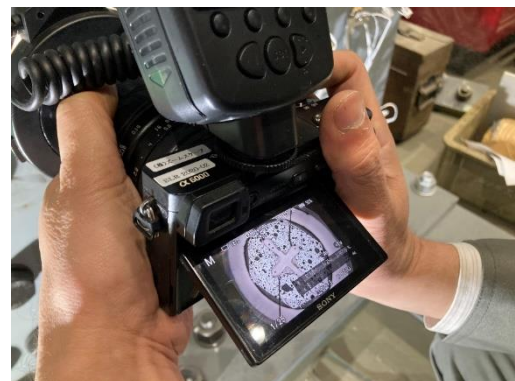
(f) ボルト A : 画像計測状況
