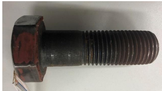
(d) 抜き取った高力ボルトのねじ軸部
