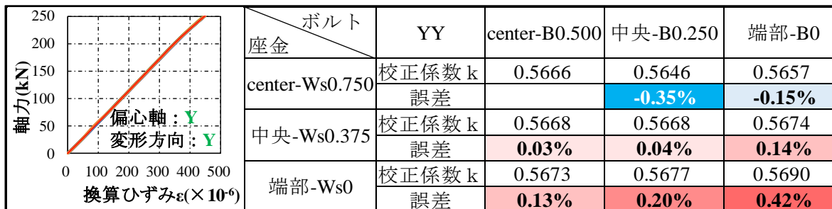
(d) 偏心軸を横方向(Y)にした場合 Y 軸方向変形
