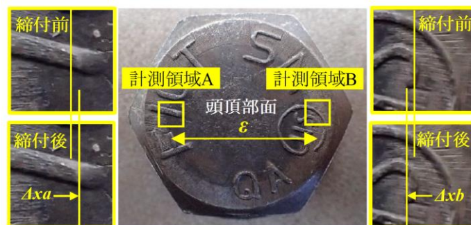
図 6-2 締付け前後のボルト画像計測領域の抽出画像比較例
