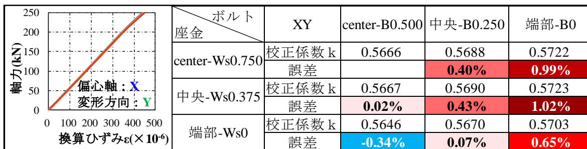
(b) 偏心軸を横方向(X)にした場合 Y 軸方向変形
