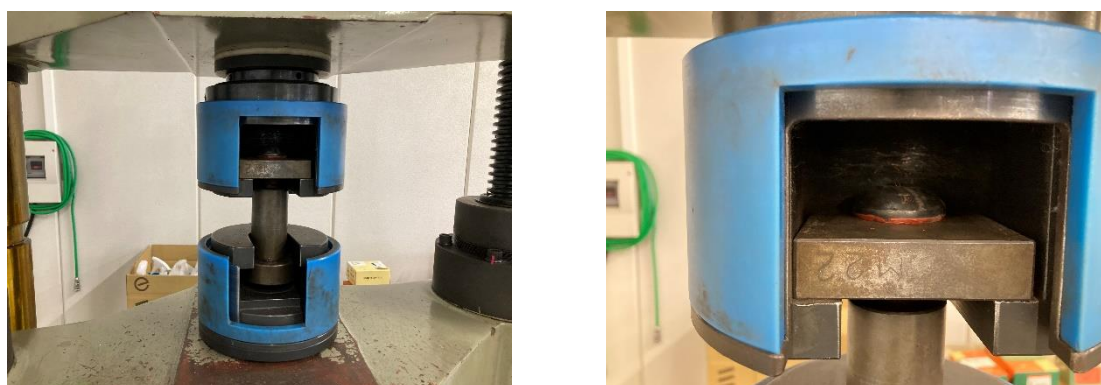
写真 2-13 抜き取りボルトの引張試験状況
