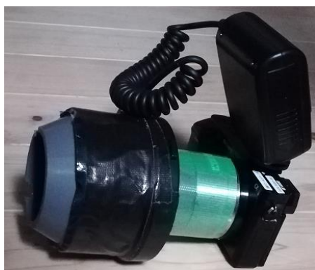
写真 6-5 近接マクロ撮影装置
