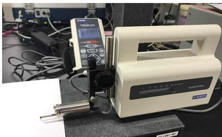
写真 2.5.6 表面粗さ計 SURFCOM FLEX -50
