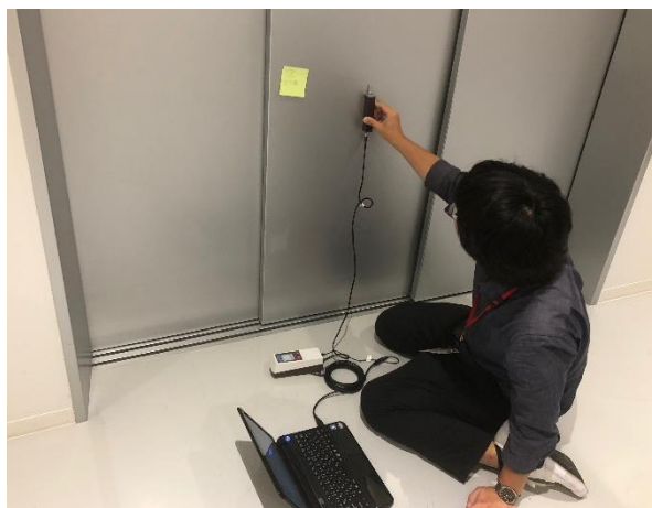
写真 3.6.1 線粗さ測定状況
