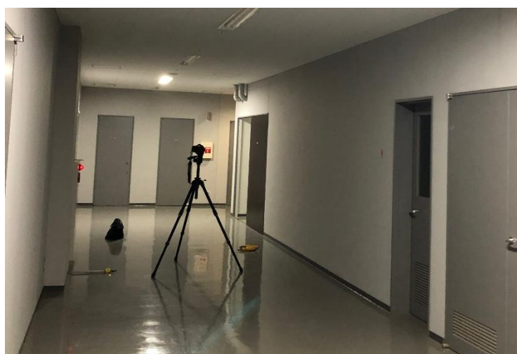
写真 6.3.2 輝度分布の測定状況
