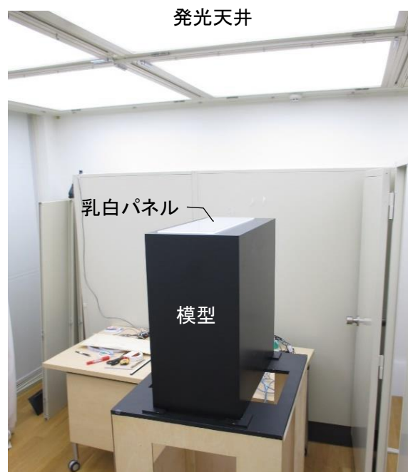
写真 5.3.2 拡散光源での配置
