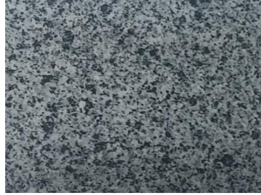
d) No. 9 花崗岩 ジェットアンドホリッシュ (J&P) 仕上げ
