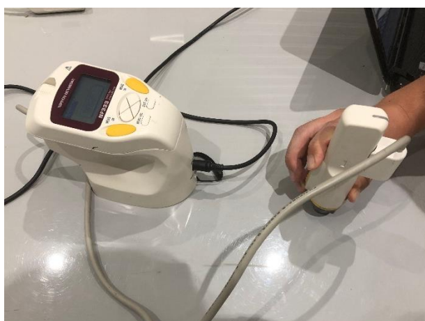
写真 3.6.3 拡散反射率測定状況
