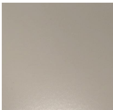
No. 21 ブリキ板ポリエステル系樹脂粉体塗料 5分艶仕上げ（薄橙）
