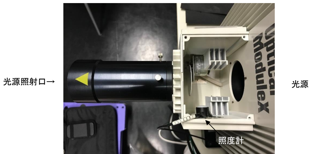
写真 2.3.2 照度計設置状況
