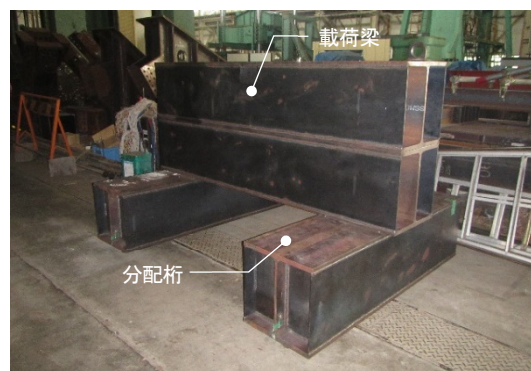
写真-3.8 荷重梁と分配桁
