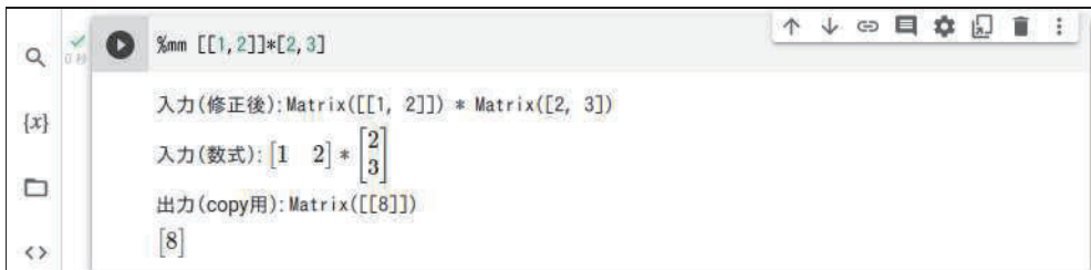
図 6: 簡易文法修正マジックコマンドの実行例 (空白や添字の扱い)
