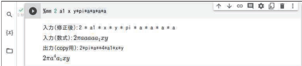
図 6: 簡易文法修正マジックコマンドの実行例 (空白や添字の扱い)
