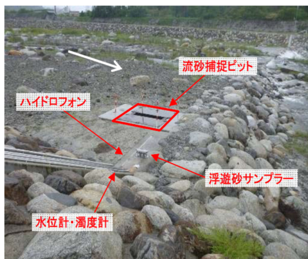
図 3-3 観測機器の設置状況 11)
