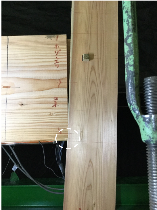
(a) 柱割裂前の差鴨居下端繊維切断（負加力時）
