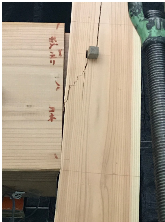
(c) 試験体 K_B 0.1rad 負加力時 接合部全体
