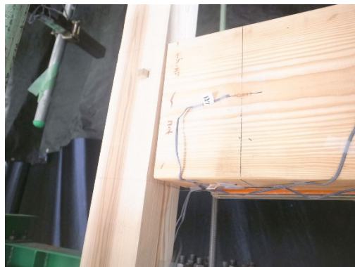
写真 5-2 込栓試験体 K 左接合部の負加力時変形状況
