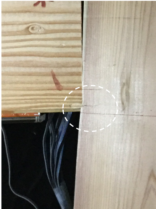
(a) 試験体 K 0.1rad 負加力時
