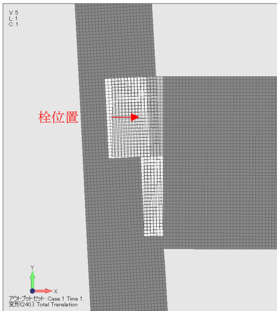
(b) 左柱（前柱）接合部変形状態
