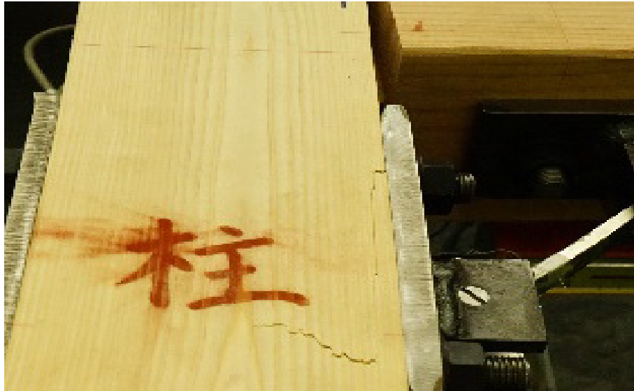
(a) 試験体 K_P 左柱曲げ破壊
