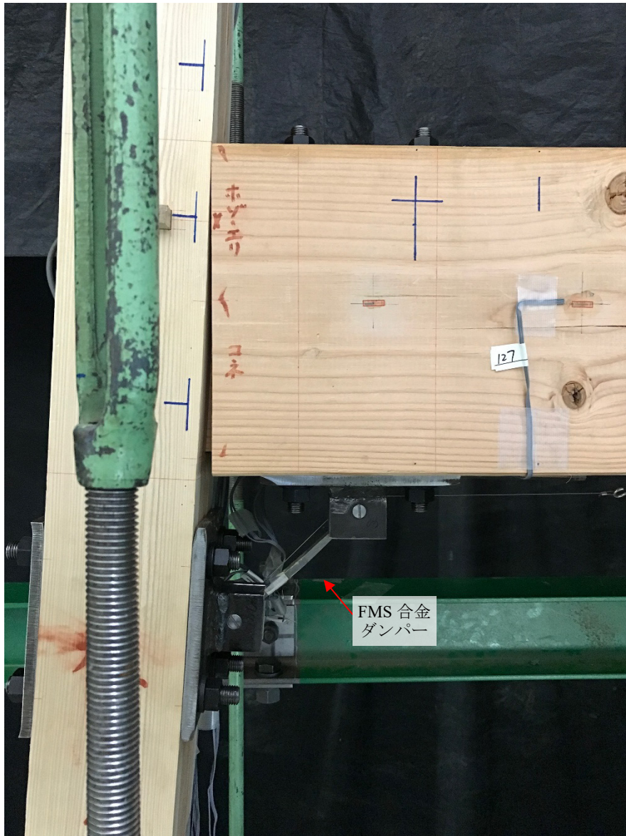
写真 3-10 試験体 K_P 0.1rad 負加力時 FMS 合金ダンパー変形状況
