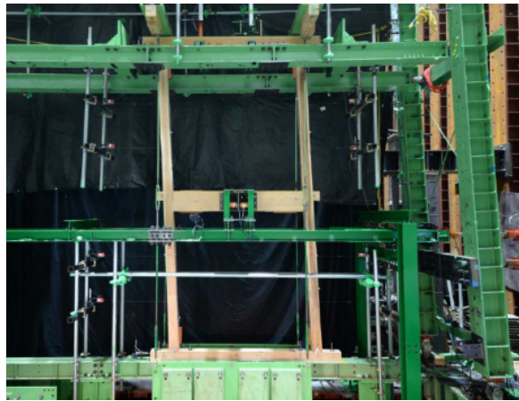
写真 2-2 加力状況 (試験体 H, 正方向)
