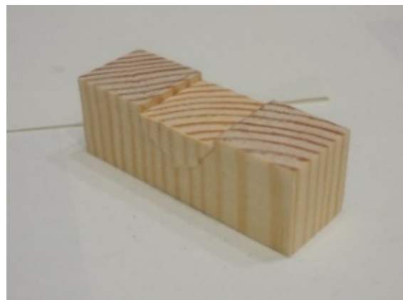
(b) 繊維方向の部分圧縮試験
