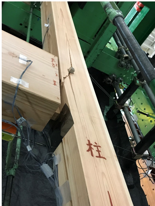
(b) 試験体 K_B 右柱曲げ破壊状況
