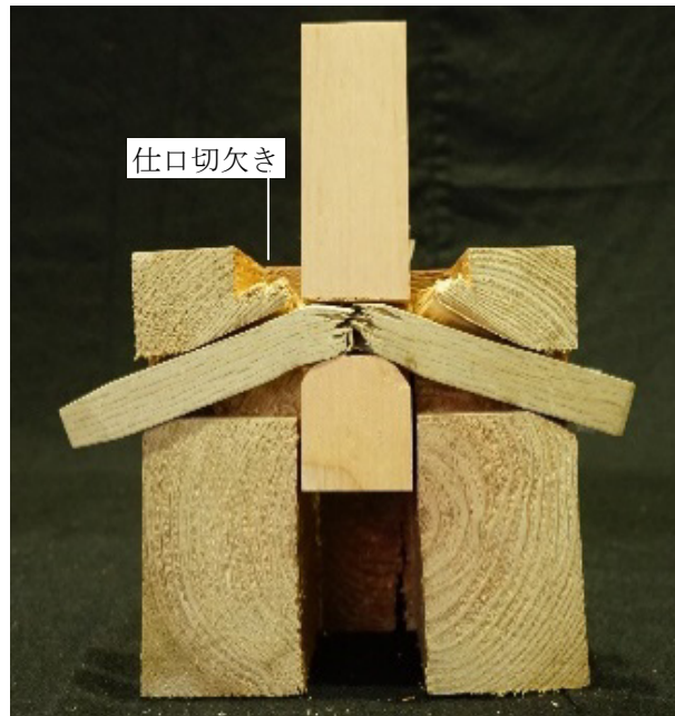
写真 5-6 栓の曲げ降伏 M6・柱のめり込み M2a (UBKA365)
