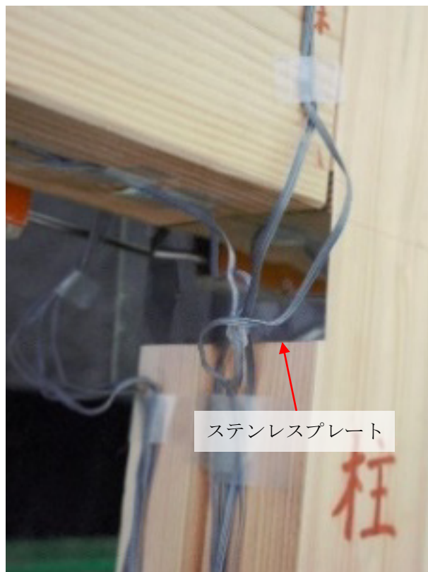
写真 3-3 試験体 K_B ステンレスプレート設置状況
