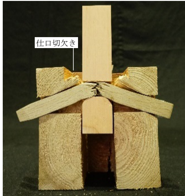
写真 4-4 栓の曲げ降伏と柱のめり込み (UBKA365)
