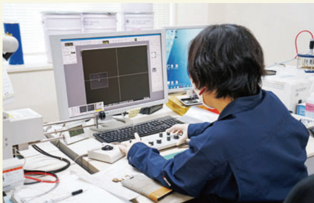
できあがったペロブスカイト層は顕微鏡で確認し、表面のなめらかさをチェック
