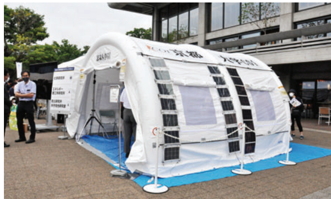
災害用テントにペロブスカイト太陽電池を設置。実証実験に成功
