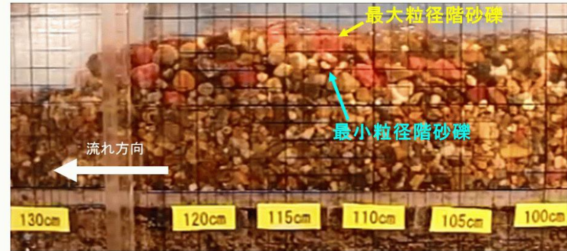
土石流先頭部の様子 (和田らの既往実験)
