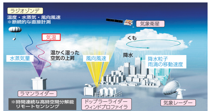
気温・水蒸気ラマンライダーの気象分野における活用イメージ。雲生成前の大気を計測することで、大雨をもたらす雲の発生をより早期に予測できることが期待されています。
