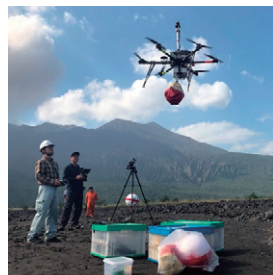
図1 ドローンをを用いた噴石模型落下実験
