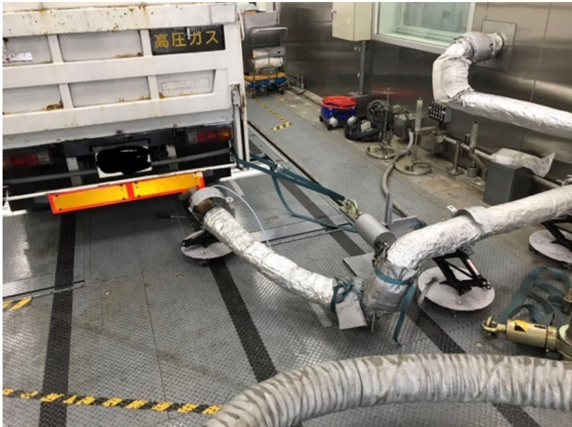
図 3.3.2 排出ガスの収集方法
