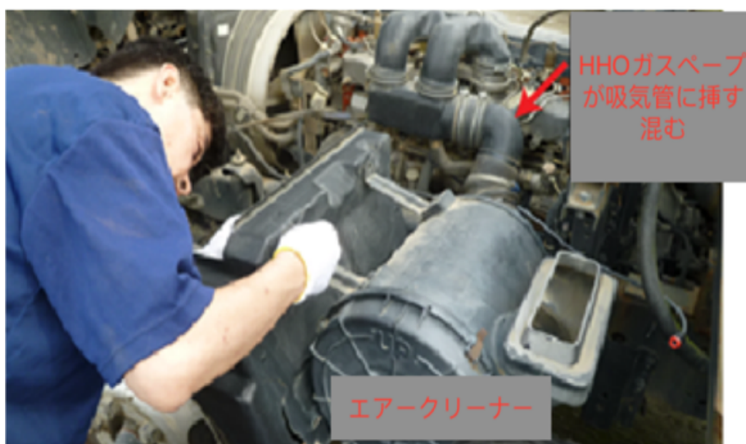
図 3.2.4 HHO ガス導入方法
