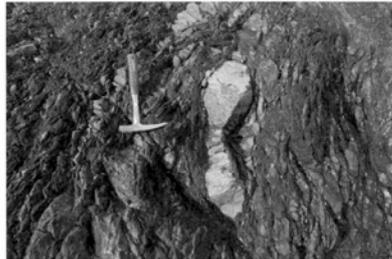
写真1-1 典型的なブロックインマトリクス構造
