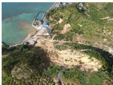
角礫化帯の強風化部が大土石流に発達した例
