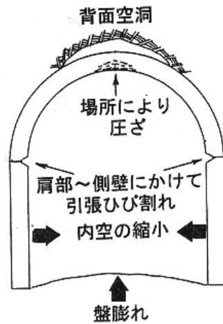
図-5.3.3 変状模式図（横断面図）
