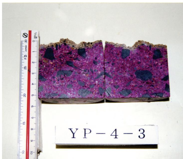
写真 9.1 中性化試験の例
