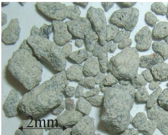
写真 4.1 微粒分が表面に固着した砕砂
