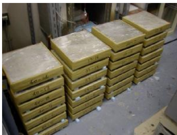
写真 3.6 養生中の熱伝導率測定用試験体
