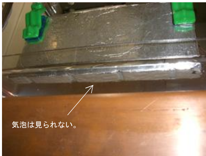
写真 4.4 試験体設置状況（吸水面の様子）
