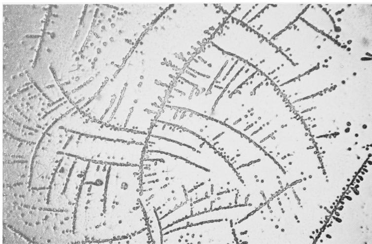
Fig. 1 精漿樹枝状結晶 太型 ×100
