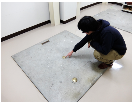
図 3: (a) 基台中央にある金属標が重力点「京都 C」、基台手前側にある金属標が重力点「京都 FGS」。 (b) 京都 C で得られた絶対重力値 (東ほか, 2002 に加筆)。白塗り赤線の丸は国土地理院によって 2003 年 5 月に得られた絶対重力値、赤塗り黒線の丸は京都大学測地学研究室によって 2011 年 4 月に得られた絶対重力値である。
