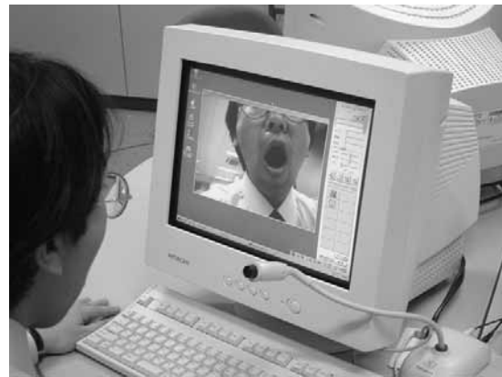
図 1.33: CCD カメラによる口唇形状の確認
