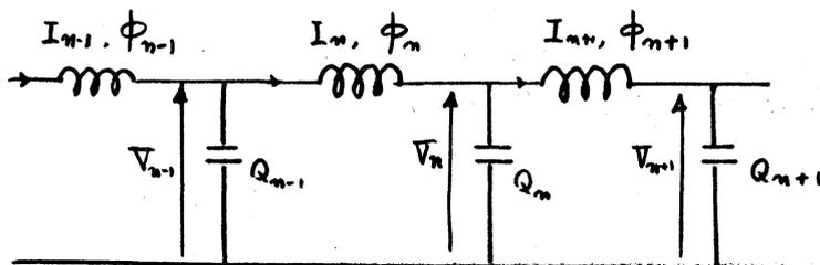
$n$  番目の Inductance を流れる電流を  $I_n$ , 磁束を  $\phi_n$ ,  $n$  番目の Capacitance にかゝる電圧を  $V_n$ , そのに蓄積された charge を  $Q_n$  とすると、次の方程式が得られる。
