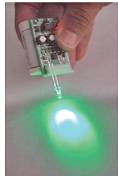
図 2. (11 \bar{2} 2)InGaN/GaN QW LED の電流注入による発光の様子 (緑色)
