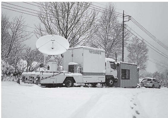
図1. 群馬県みなかみ町宝台樹における車載型ミリ波ドレーダーによる観測の様子
