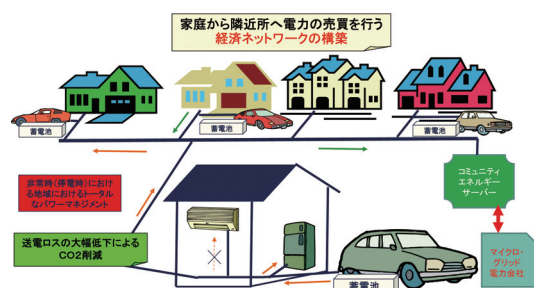
図11 地域内ナノグリッドによるエネルギー売買市場の創成
