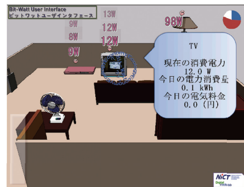
図6 家電ごとの電力消費量の見える化(情報通信研究機構との共同研究)
